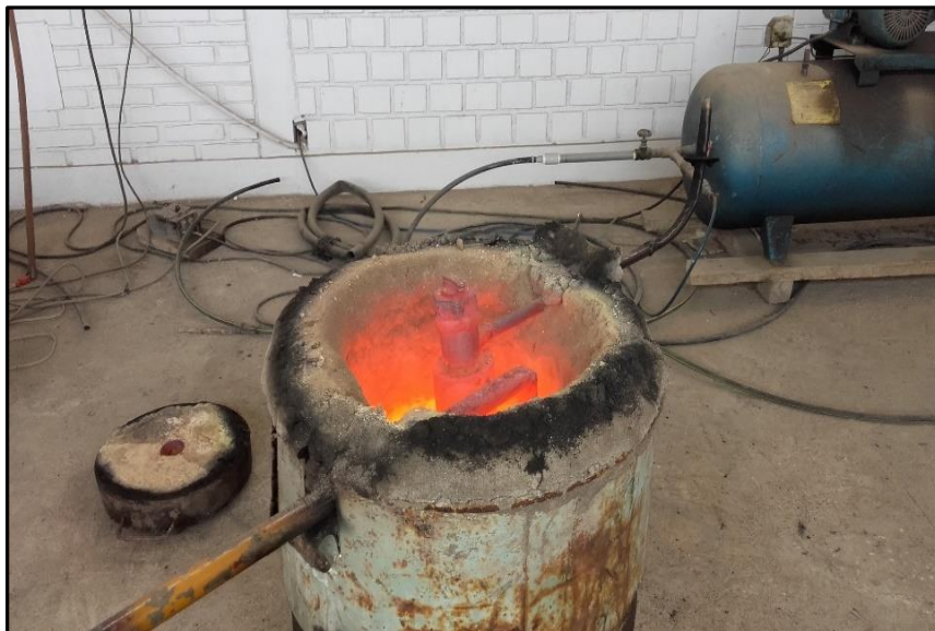
Anexo 2. Horno con el reactor de reducción directa. Fuente: Elaboración propia.
