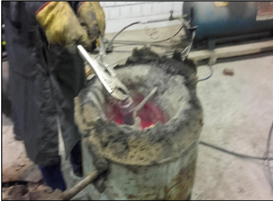
Anexo 3. Operación de retiro del reactor de reducción directa. Fuente: Elaboración propia.
