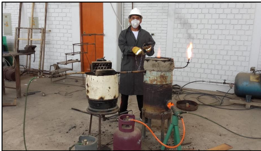
Anexo 1. Hornos de obtención de hierro esponja. Fuente: Elaboración propia.
