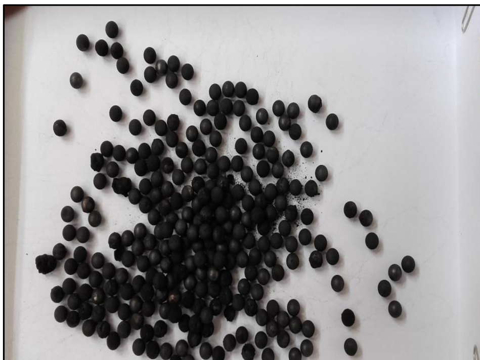
Figura 11. Hierro esponja producido con pellets provenientes de El morrito Sama. Fuente: Elaboración propia.
