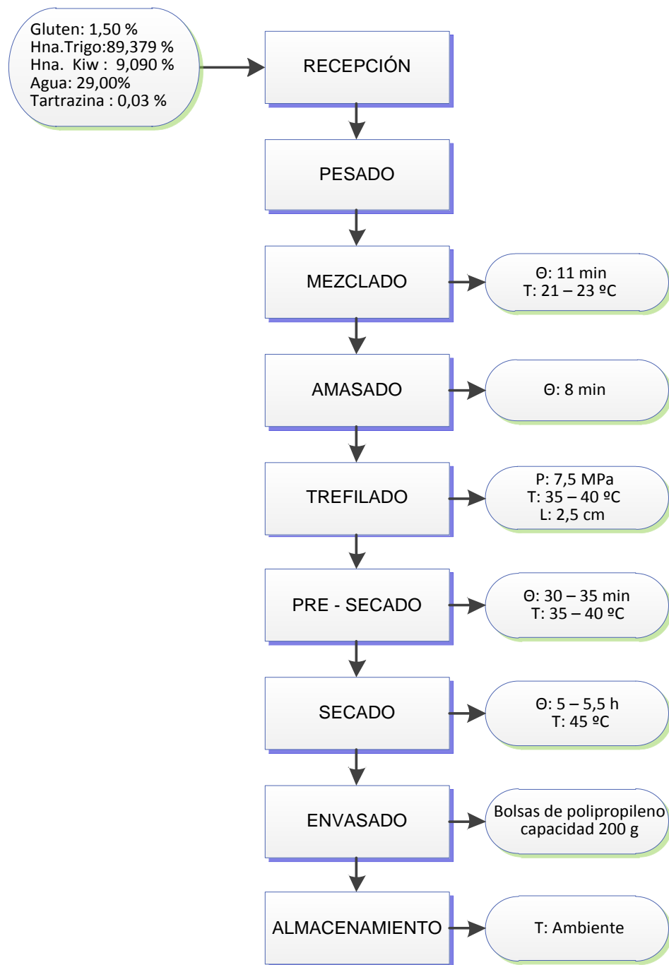
Figura 19. Flujo definitivo de procesamiento para la elaboración de fideos
