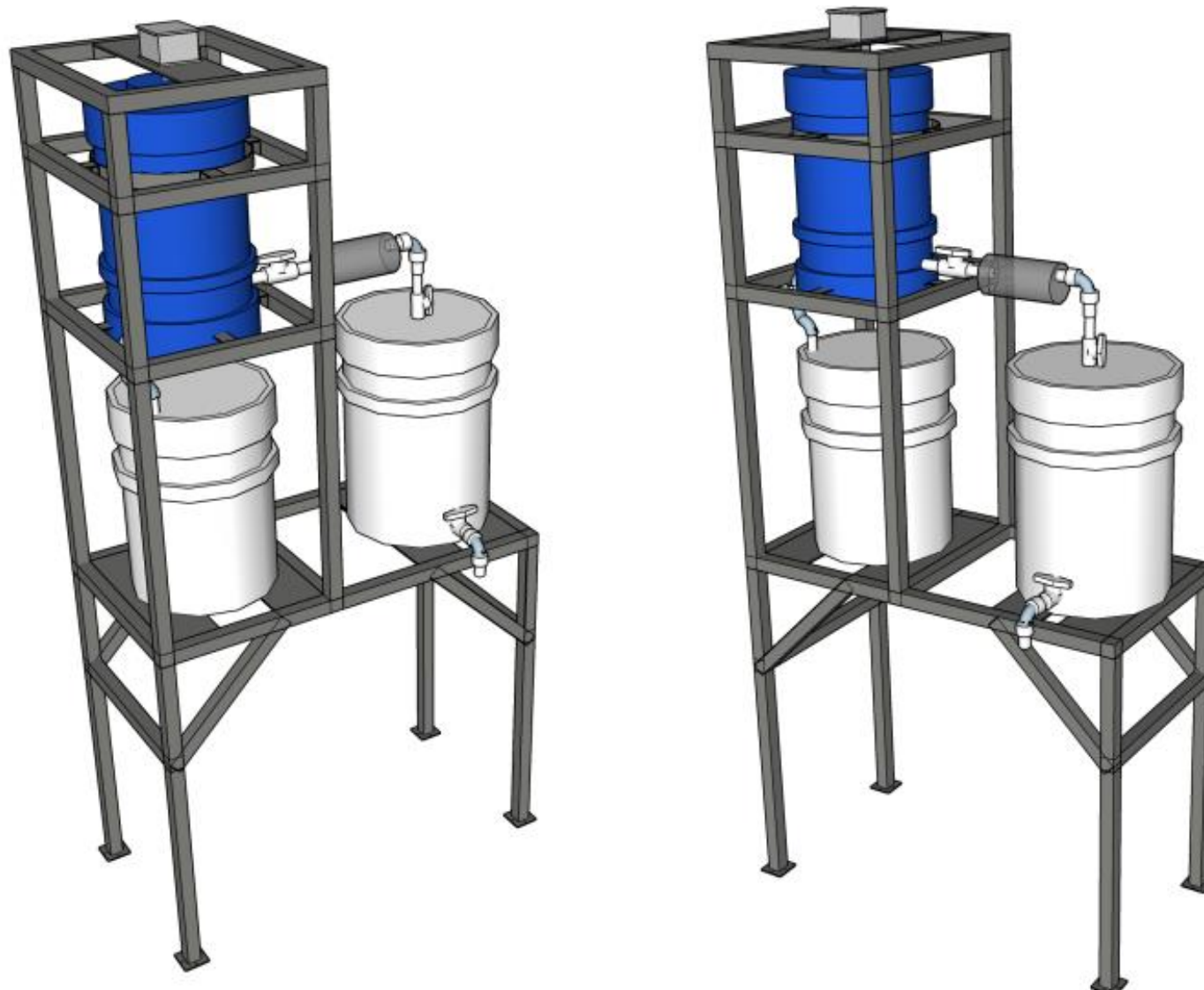
VISTA TRIDIMENSIONAL DE LA ESTRUCTURA Y SOPORTE DEL REACTOR QUÍMICO BATCH, PARA LA REDUCCIÓN DEL CONTENIDO DE ARSÉNICO A NIVEL PERMISIBLE EN EL AGUA DE CONSUMO DEL DISTRITO DE HUANUARA - TACNA
