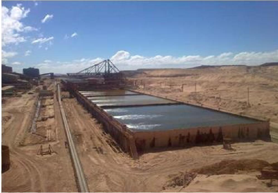
Figura 2. Lixiviación en bateas Fuente: Bustamante, 2015
