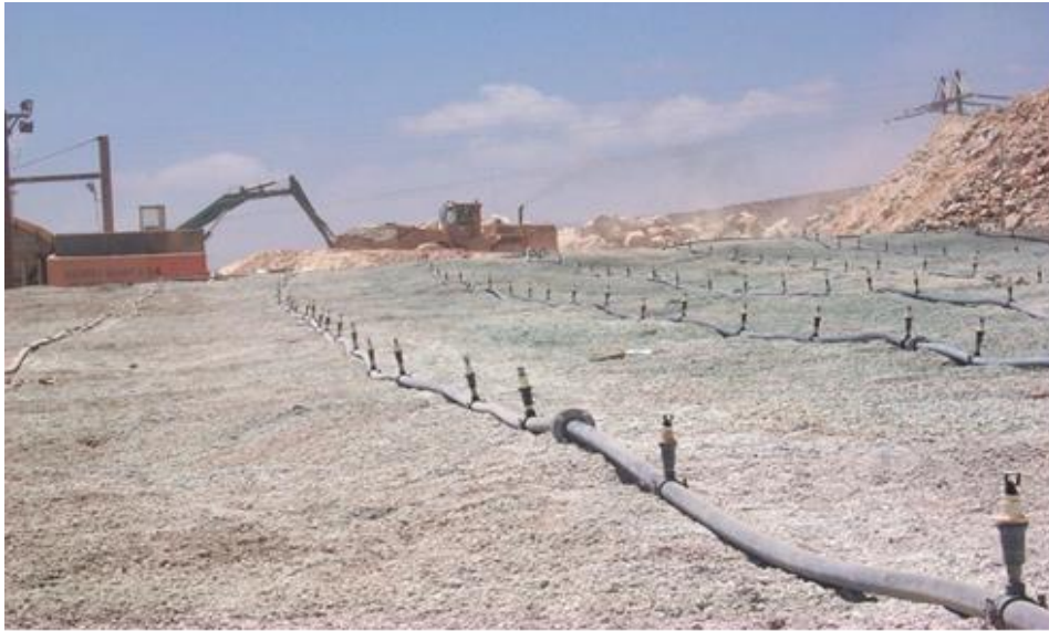
Figura 18. Lixiviación de cobre por aspersion Fuente: SPC - Cuajone
