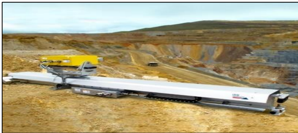
Fotografía 2. Radar de apertura sintética, IDS GeoRadar.
