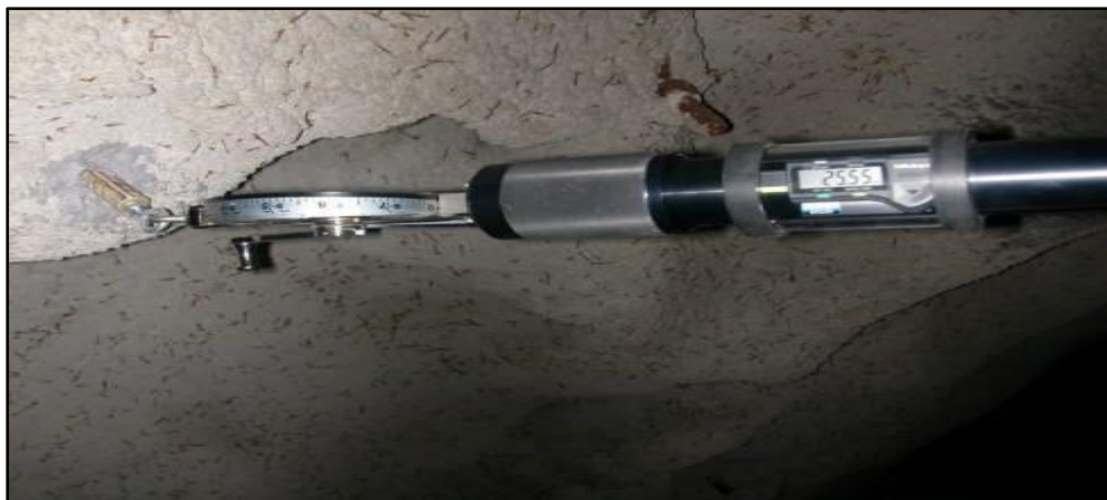
Fotografía 1. Extensómetro de cinta.
