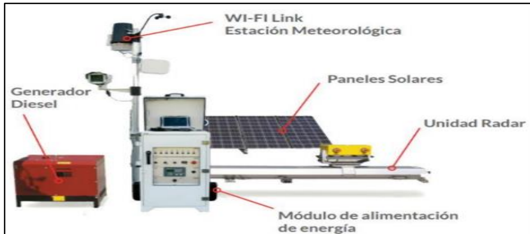
Figura 15. Hardware del GeoRadar, IDS GeoRadar
