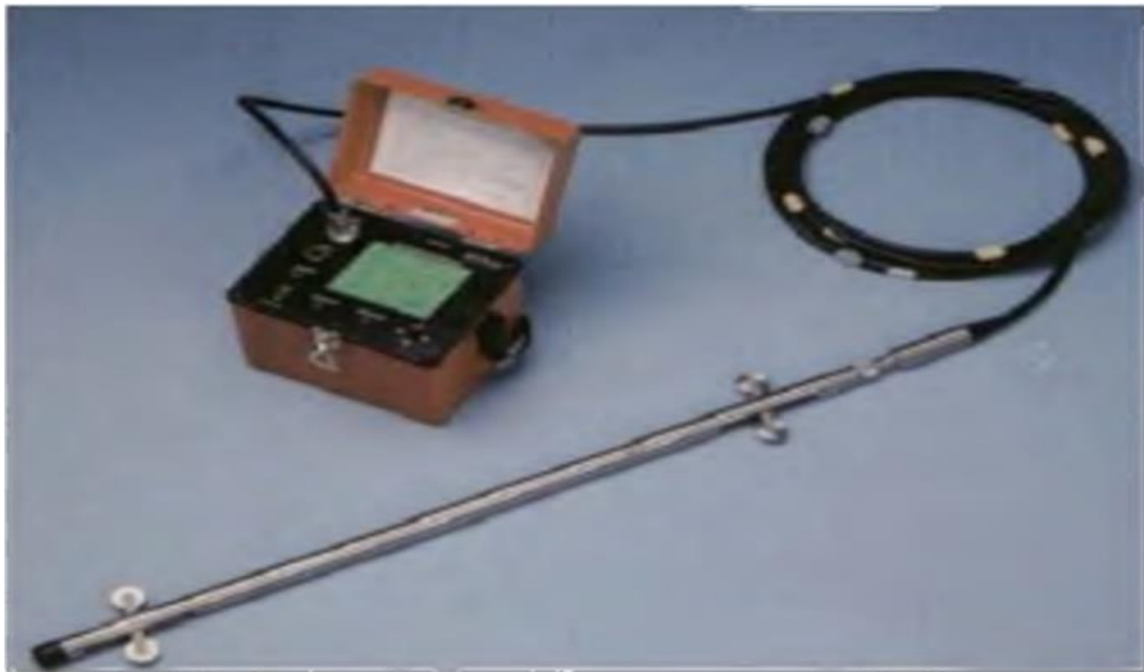
Figura 18. Equipo inclinométrico (cortesía de Ingeniería de Instrumentación y Control.)
