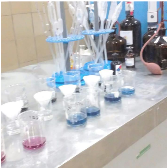
Figura 7. Análisis de cianuro libre en el laboratorio químico Fuente: Recolección propia
