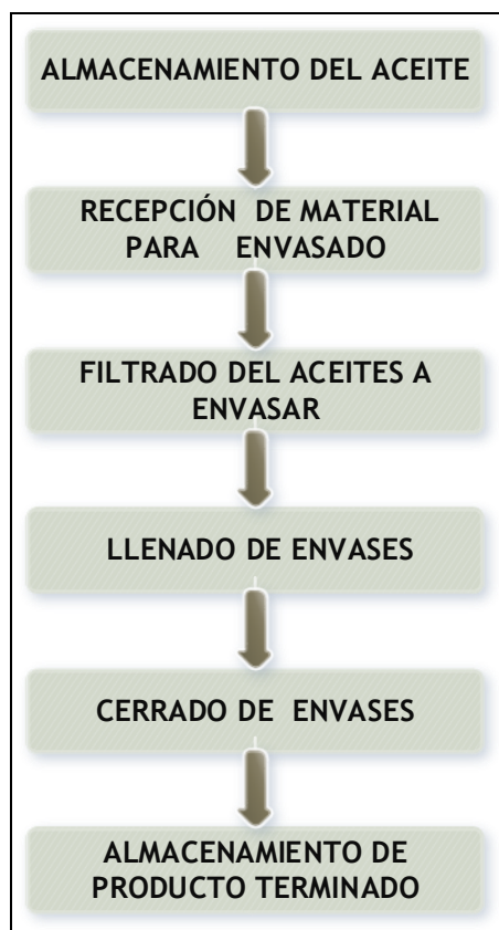
Figura 11. Diagrama de flujo de la línea de envasado del aceite de oliva virgen.
