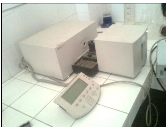
Figura 9. Espectrofotómetro utilizado en la determinación de los coeficientes de extinción y polifenoles totales
