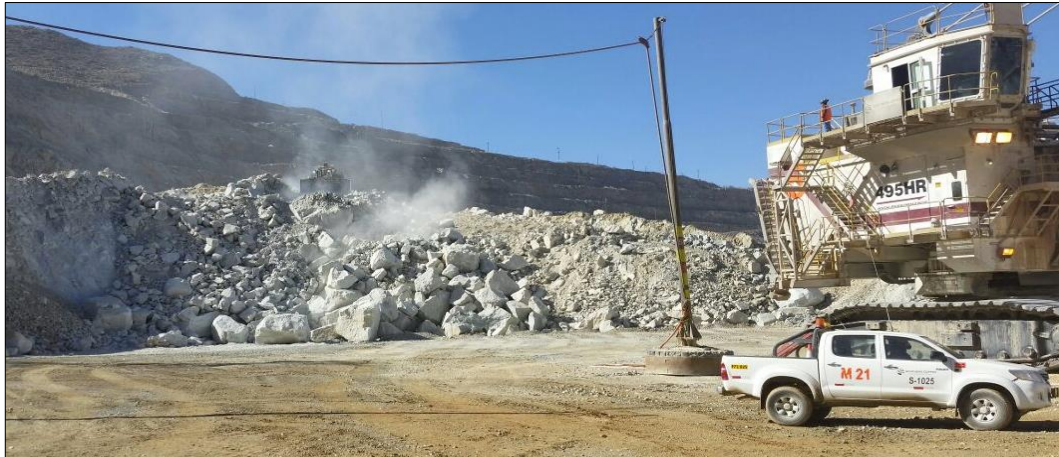
Figura 38. Fragmentación gruesa en corte de pala Fuente: SPCC, 2018.
