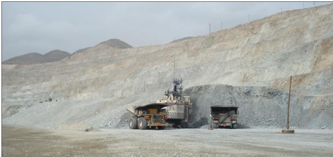
Figura 34. Esponjamiento de la pila de mineral Fuente: SPCC, 2018.
