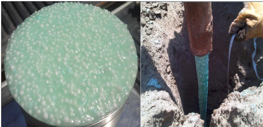
Figura 29. Control de mezcla explosiva Fuente: SPCC, 2018.
