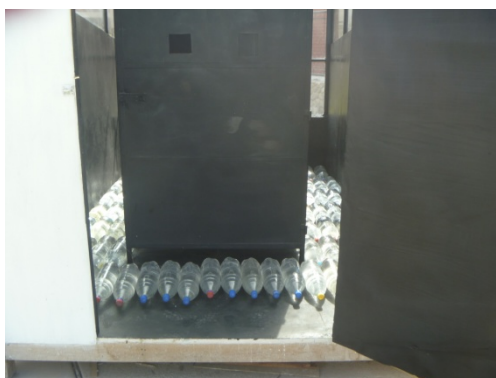
Figura 70: SSS como acumulador térmico el agua contenida en botellas descartables.
