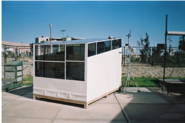
Figura 35: Medida de la humedad relativa en el interior de la caja metálica utilizando el sensor de humedad de la estación HOBO por ser inaccesible para el higrómetro HM-34 y la medida de la velocidad del viento con anemómetro de la estación HOBO a 10 cm. sobre la superficie inclinada.
