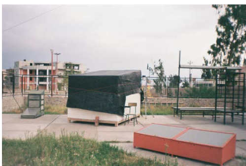
Figura 71: Proceso de enfriamiento de la SSS como acumulador térmico el agua contenida en botellas descartables.
