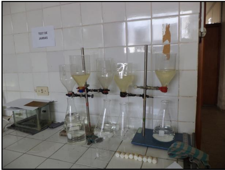
Figura 20. Proceso de filtración
