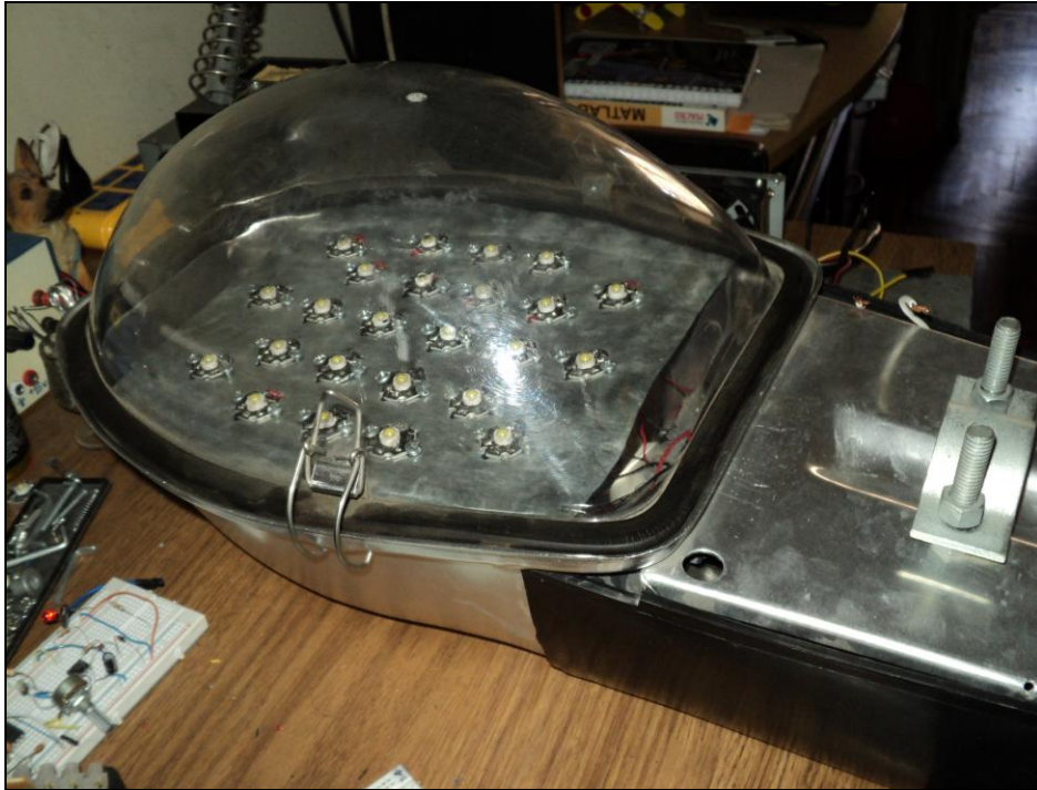
Figura 82: Luminaria Led ensamblada.
