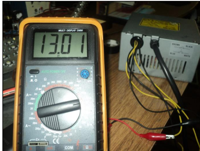
Figura 63: Voltaje de tensión de nuestra fuente estabilizada modificada.
