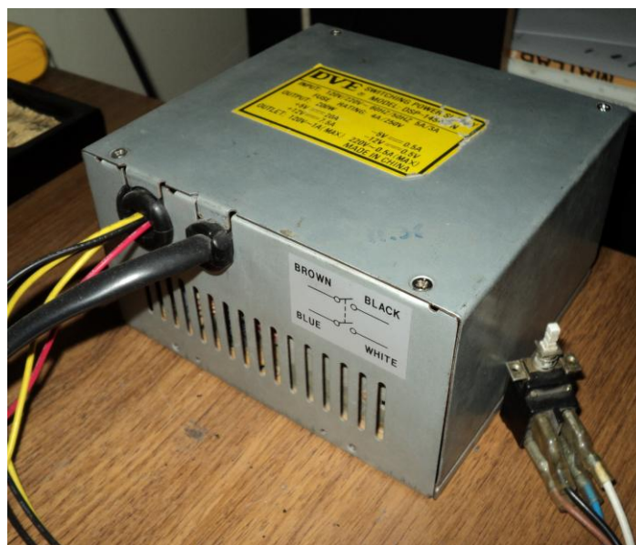
Figura 57: Fuente de PC AT- de 12V y 7,5 A Fuente: propia FOTOGRAFÍA (2014)
