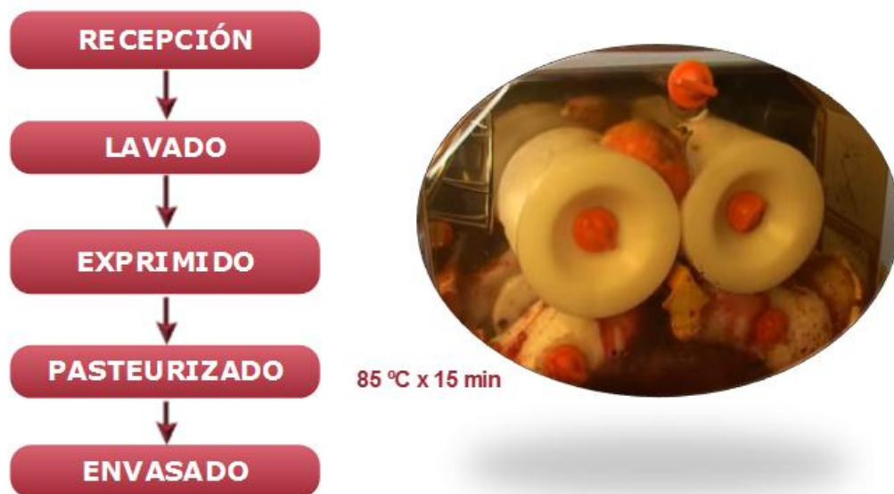
Figura 4. Extracción mecánica del jugo de granada Fuente: Sandoval (2015)
