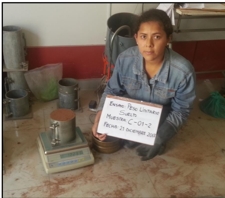
FOTO 06: Ensayo de Peso Unitario suelto
