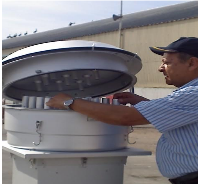
Figura 9. Instalación de equipo muestreador MP10
