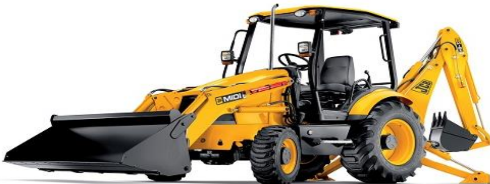
Figura 37 Retroexcavadora JCB 3CX.
