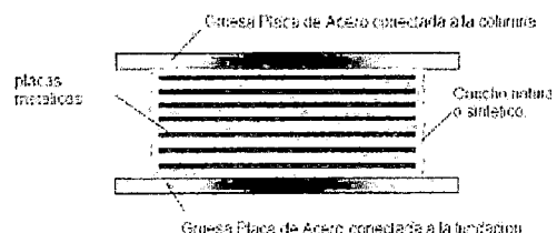
Esquema de un aislador elastomérico moderno
