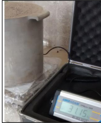
Figura 42. Peso de la muestra suelta más vasija para Peso unitario compactado agregado fino.
