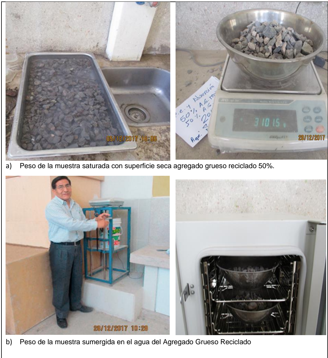
Figura 41. Peso específico y porcentaje de absorción agregado grueso reciclado.
