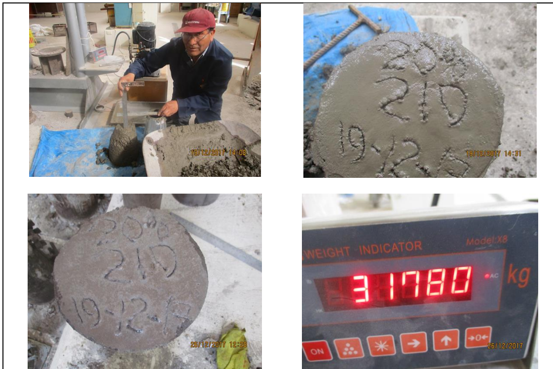
Figura 47. Resistencia a compresión de diseños f'c=210 \text{ kg/cm}^2 con 20% de agregado reciclado.
