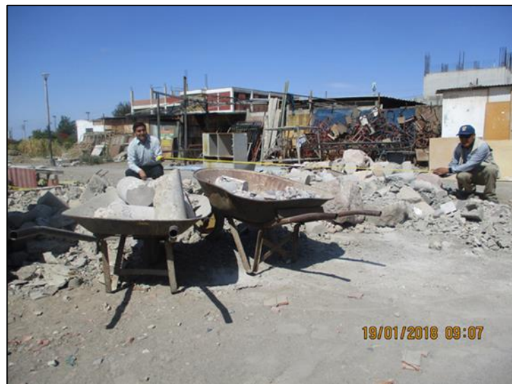
Figura 20. Agregado grueso reciclado a partir de escombros de la C.U. UNJBG.
