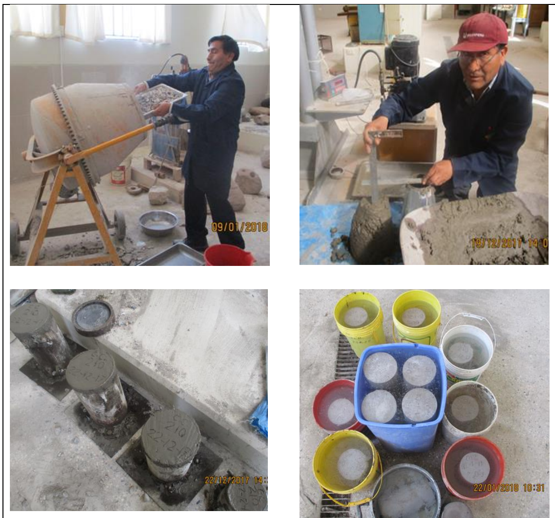
Figura 45. Diseño de mezcla; mezclador, asentamiento, moldeado y curado de briquetas.
