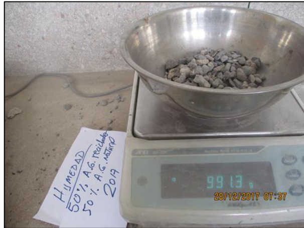
Figura 43. Peso de la muestra secada al horno agregado grueso reciclado 50%.
