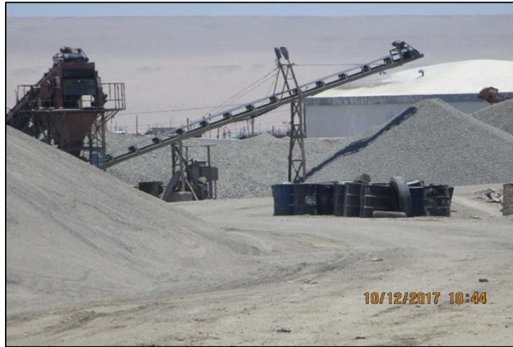
Figura 7. Tolva con una criba de corte a través de una cinta transportadora en las Canteras de Viñani en el D.C.G.A.L.-Tacna.
