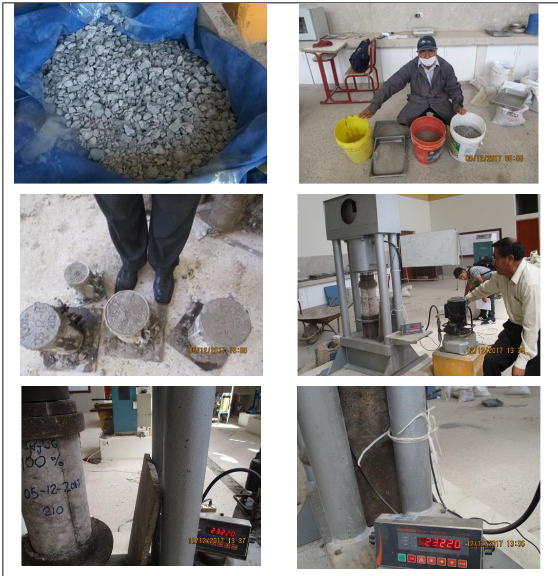
Figura 51. Resistencia a compresión de diseños f'c=210 \text{ kg/cm}^2 con 100% de agregado reciclado.
