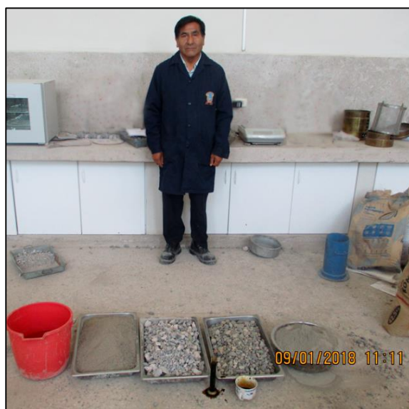
Figura 44. Dosificación diseño de mezcla; agua, cemento, agregados fino, grueso reciclado y aditivo.
