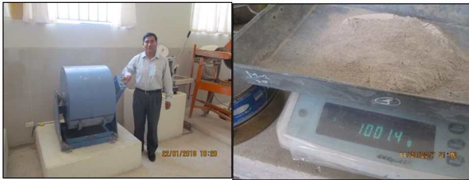
Figura 38. Peso de material que pasa el tamiz N° 12 de agregados gruesos reciclados 1001,4 gr.
