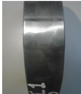
Figura 62. Doblado de cara de la probeta soldada. Fuente: Propia.
