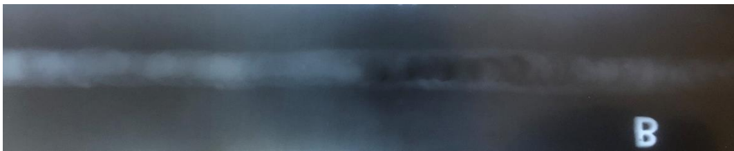
Figura 34. Ejemplo de placa radiográfica con baja absorción. Fuente: Propia.
