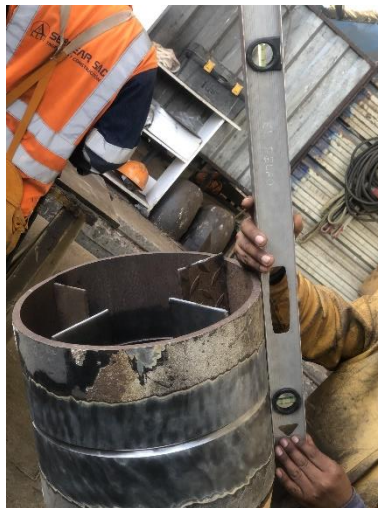
Figura 48. Posición para la calificación del procedimiento de acuerdo API1104. Fuente: Propia.
