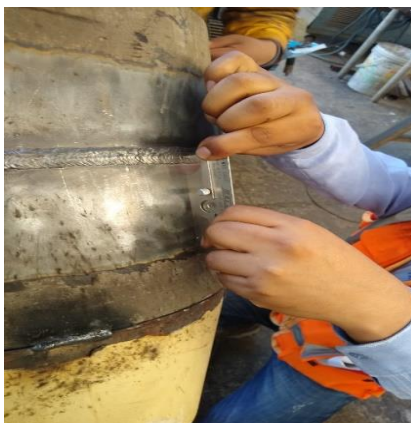
Figura 53. Inspección visual de soldadura al culminar el soldeo de la probeta.
