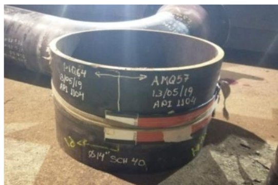
Figura 56. Inspección de placa radiográfica de tubería de 14". Fuente: Propio.
