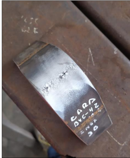
Figura 21. Ensayo de doblez con resultados rechazados (fisura) Fuente: propia.
