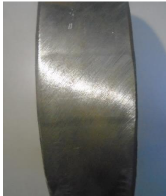
Figura 61. Doblado en raíz de la probeta soldada. Fuente: Propia.
