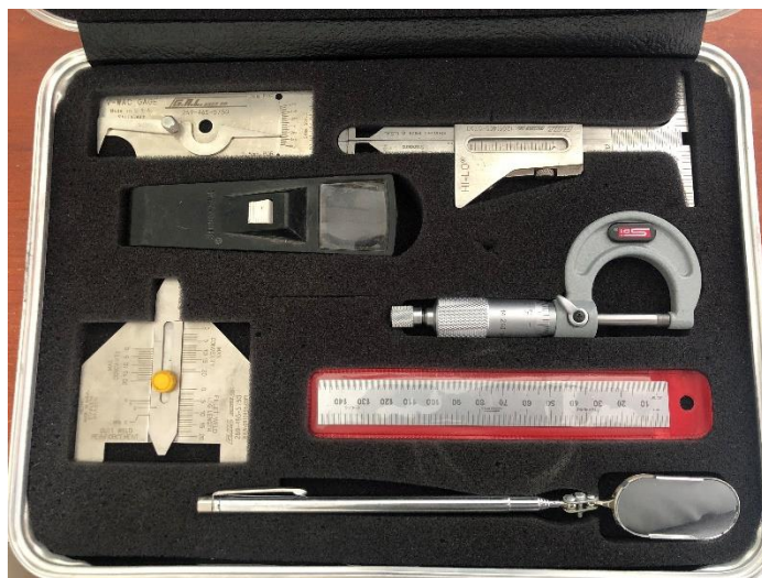
Figura 39. Maletín de instrumentos de inspección visual. Fuente: Propia
