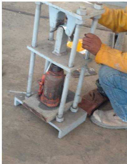
Figura 60. Dobleza de probeta soldada. Fuente: Propia.
