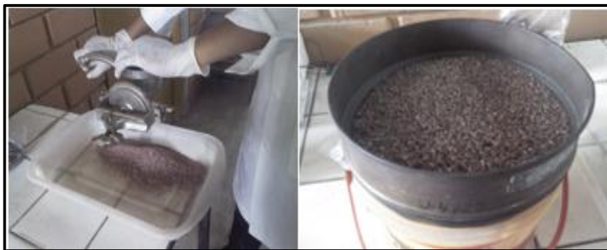
Figura 13. Molido y tamizado de los residuos de pota.
