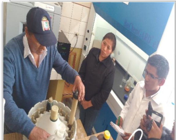
Imagen 18. Colocación de muestras a Microwave Reaction System
