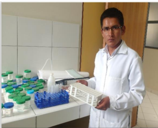
Imagen 23. Preparación de muestras para análisis de metales en ICP-OES
