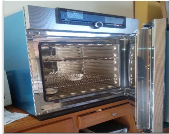
Imagen 26. Desección de muestras en equipo Memmert (deseccador)
