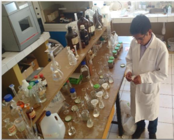
Imagen 25. Filtración de muestras para determinar sólidos suspendidos totales
