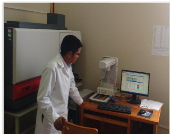
Imagen 24. Análisis de metales en ICP-OES
