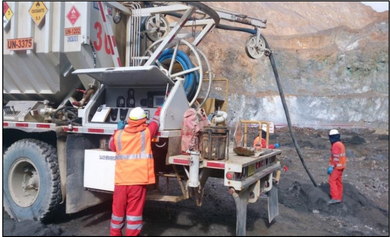
Figura 14. Camión – fábrica descargando MEQ73.
