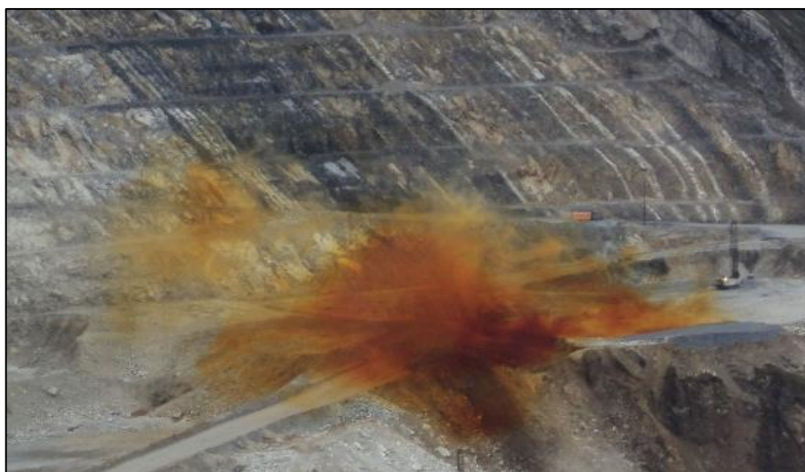
Figura 28. Emisión de gases nitrosos con Anfo pesado.
