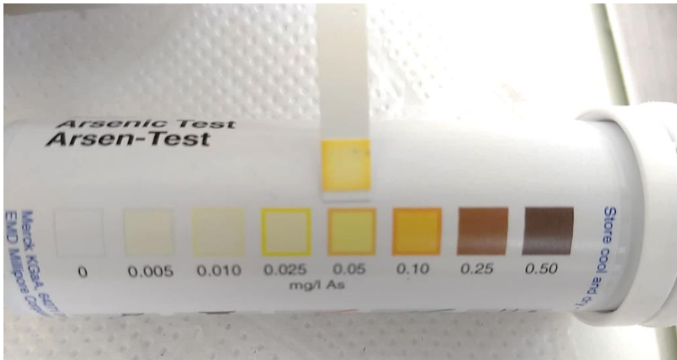
Fotografía N°21: Uso de kit comercial para medición cualitativa de la concentración total de arsénico inorgánico en agua.
