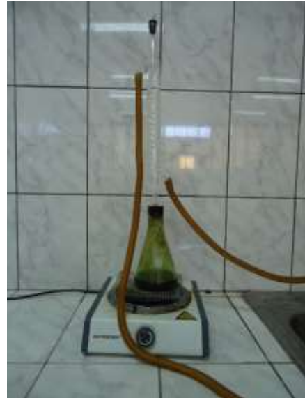
Extracción: Digestión a Reflujo
