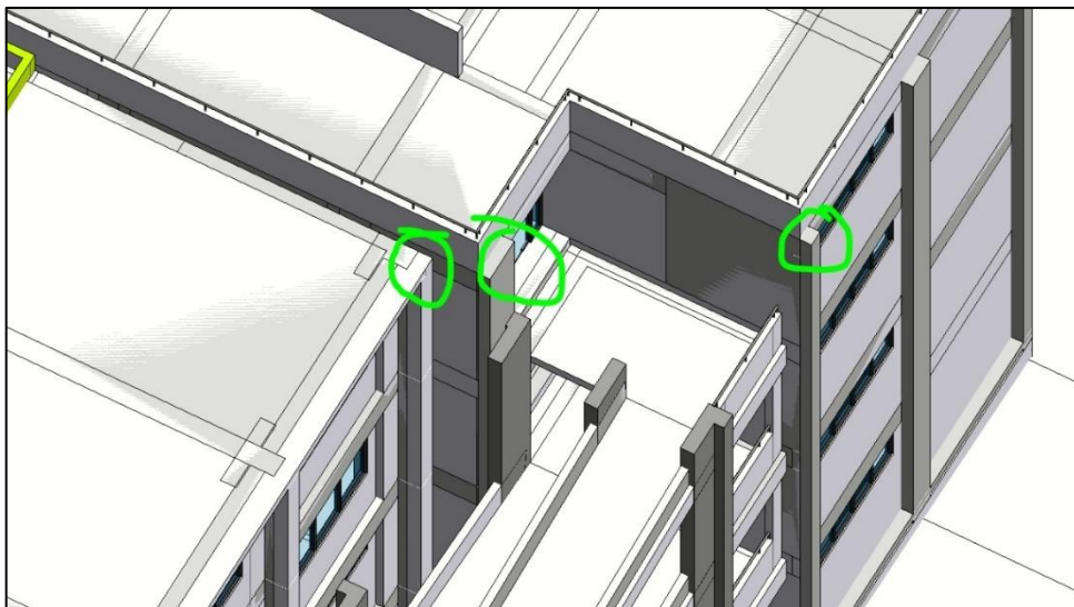
Desfase de columnas en el bloque 03
