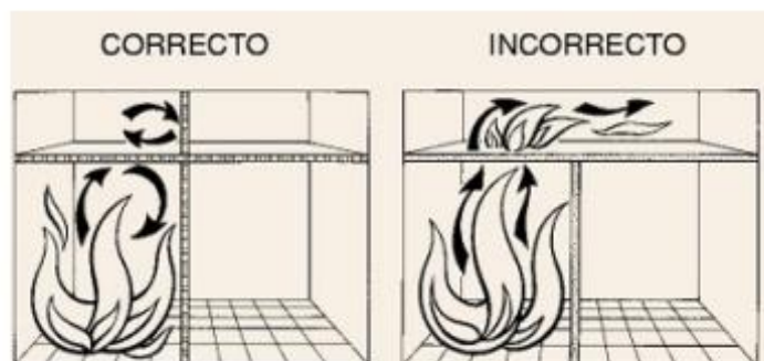
Figura 2. Tabiques y doubles techos
