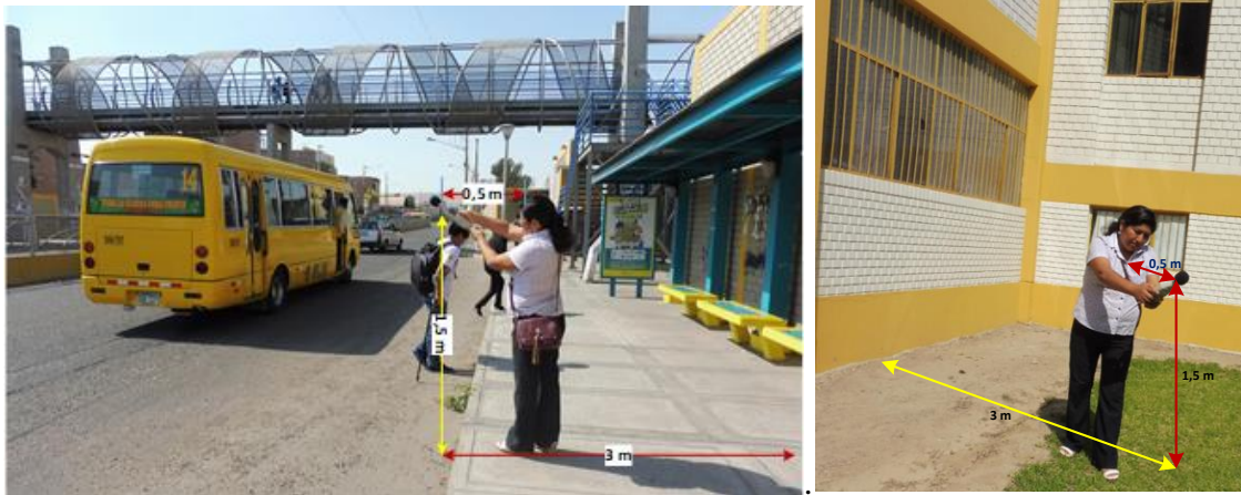
Figura 17. Modo de medición del ruido del tráfico vehicular.
