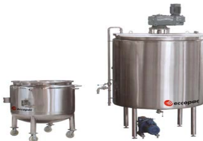
Figura N°9: Tanque de mezcla.
