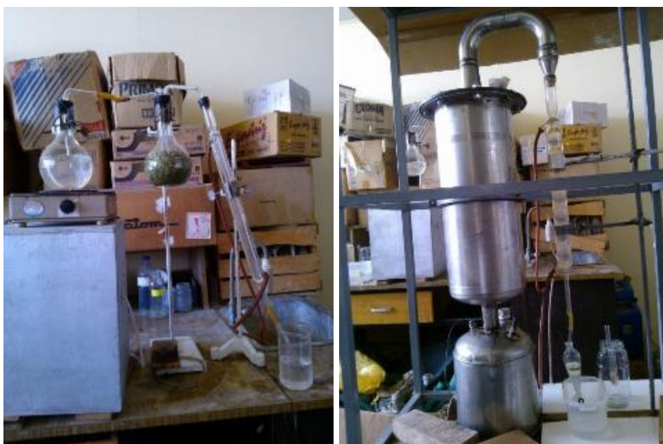
Figura 8. Equipos de extracción por arrastre de vapor Fuente: Elaboración propia, 2 015.
