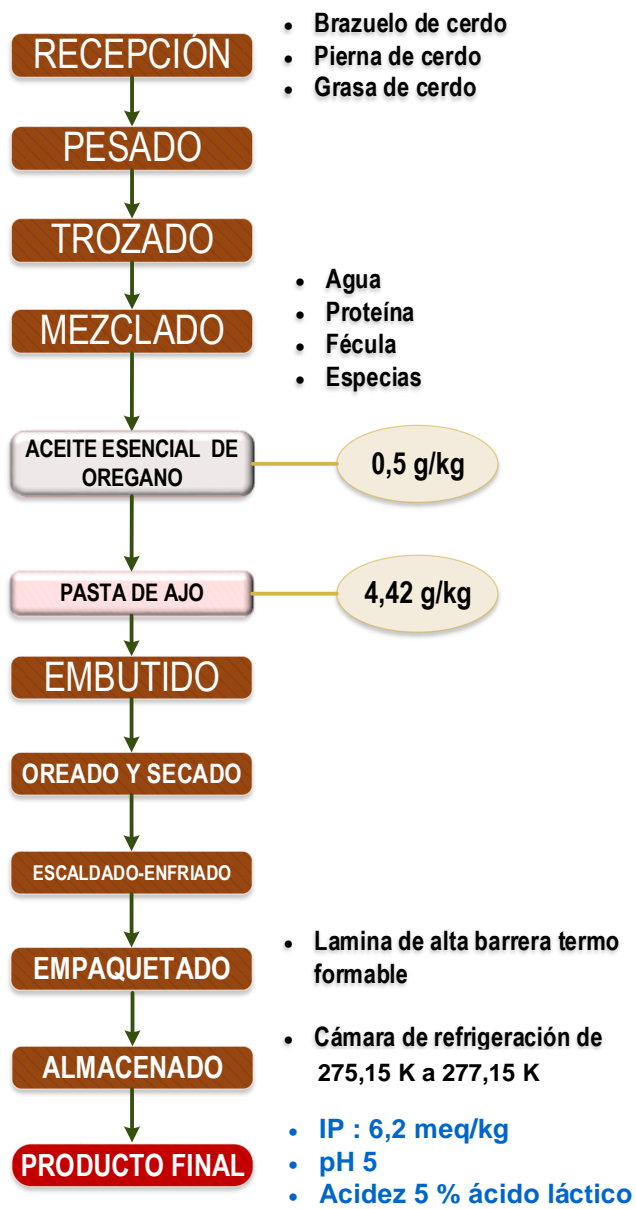
Figura 30. Flujo definitivo para la evaluación del chorizo con adición de aceite esencial de orégano y pasta ajo.
