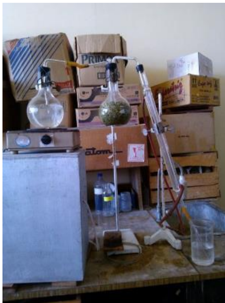
Figura 32. Extracción de aceite esencial de orégano Fuente: Archivo fotográfico personal, 2 015.
