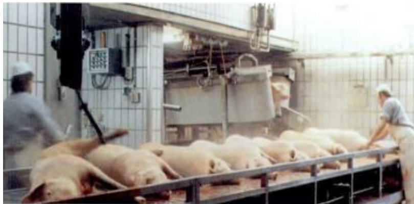
Figura N° 11. Mesa de sangrado horizontal (STORK).
