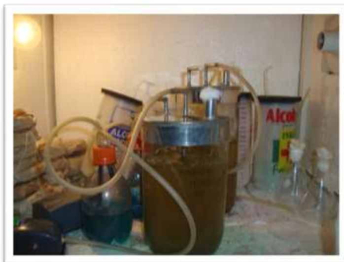
IMAGEN 02: Masificación y obtención del inoculante en el biorreactor.
