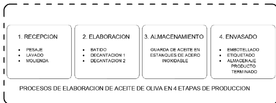
Figura 64. Proceso de elaboración de aceite de oliva. Fuente: Tesis, Almazara Comunitaria Colchagua, Andrea Castro, 2012.
