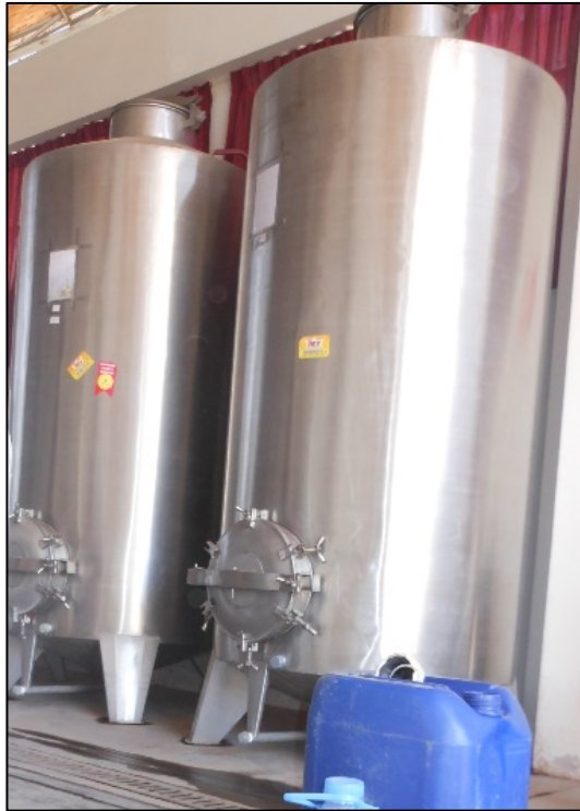
Figura 24. Tanque de Fermentación
