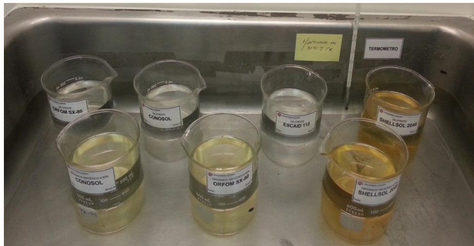
Fig. 01.- Vasos de Precipitados conteniendo los diluyentes a concentraciones del 100% y mezclados con LIX984N al 6.8%v/v extractante.
