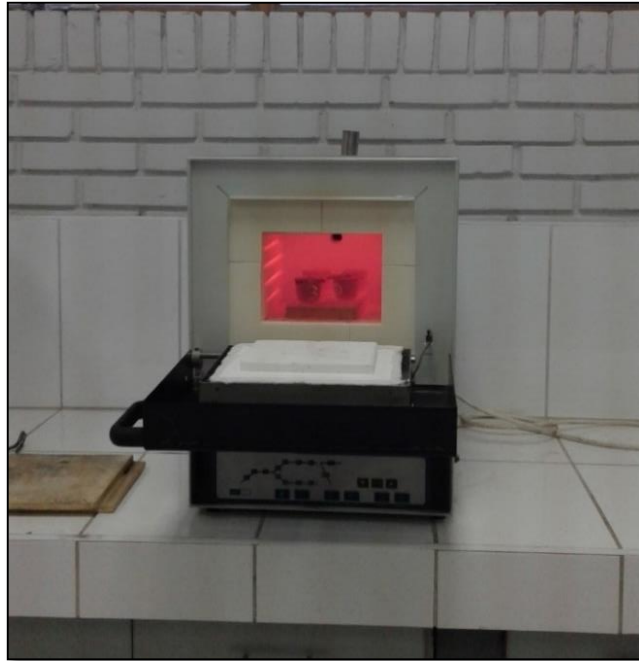
Figura 17. muestras de puzolana dentro del horno a una temperatura de 1223,15 K (950 °C). Fuente: Elaboración propia.
