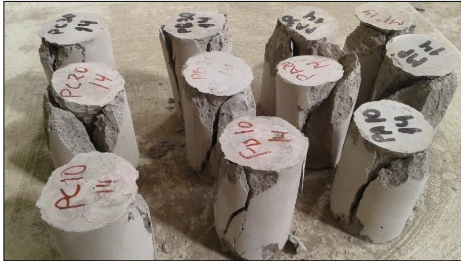
Figura 34. Rotura de las probetas a los 14 días. Fuente: Elaboración propia.
