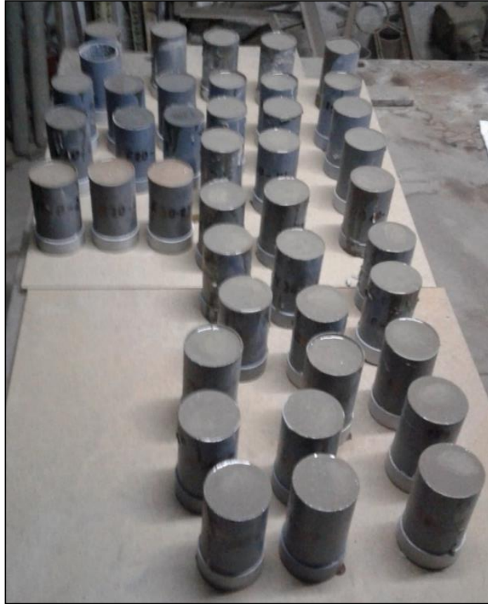
Figura 28. Moldes con las probetas compactadas. Fuente: Elaboración propia.
