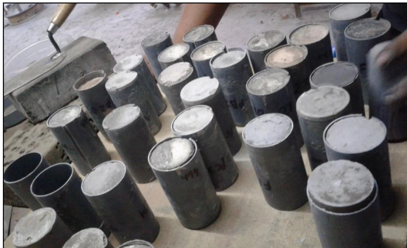
Figura 55. Desmolde después de 5 días de las muestras para el secado y las pruebas a las edades de 7; 17 y 28 días. Fuente: Elaboración propia.
