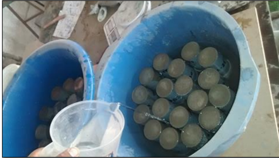
Figura 52. Probetas colocadas en dos bandejas, para que durante 5 días estén en un medio húmedo. Fuente: Elaboración propia.
