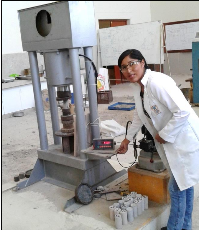
Figura 32. Datos mostrados de la carga inicial y final de la rotura de la probeta. Fuente: Elaboración propia.
