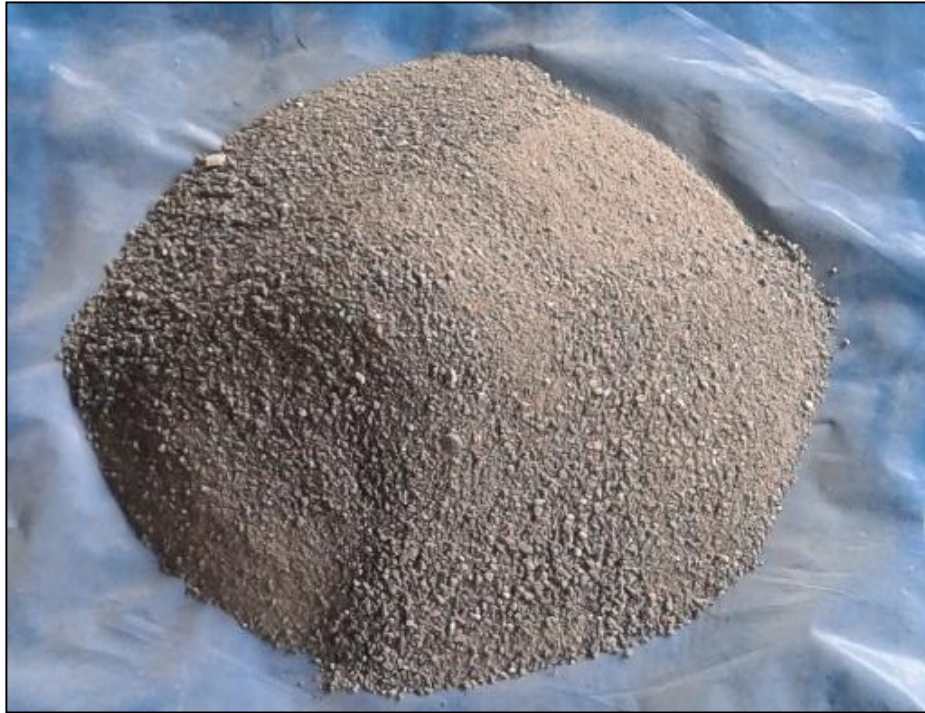
Figura 26. Granulometría del agregado supermix utilizado en la mezcla para la probeta.
