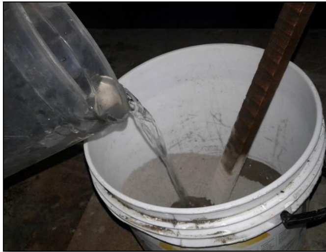
Figura 48. Mezcla del cemento, agregado, agua y un % de reemplazo de puzolana natural. Fuente: Elaboración propia.
