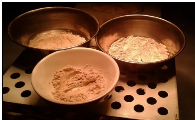
Figura 19. Secado de las muestras de puzolana natural en la lámpara durante 15 minutos. Fuente: Elaboración propia.
