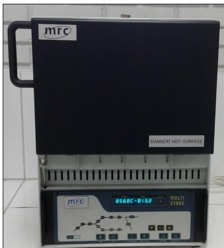
Figura 16. Horno de la marca MRC de la ESME utilizado para la determinación del % de calcinación.
