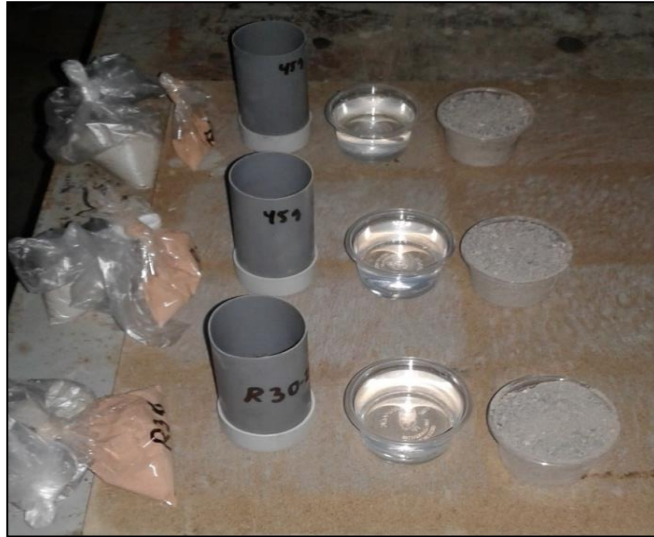
Figura 50. Materiales usados para la mezcla, se puede observar el cemento, Rcd, agregado y agua, para la edad de 28 días.
