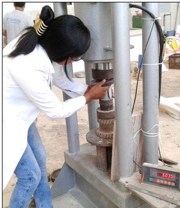
Figura 33. Ajuste de la probeta en el equipo de compresión a la edad de 14 días.
