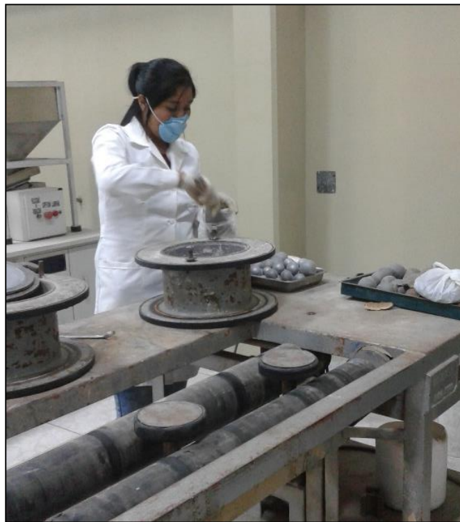
Figura 14. Retiro de las bolas del molino. Fuente: Elaboración propia.
