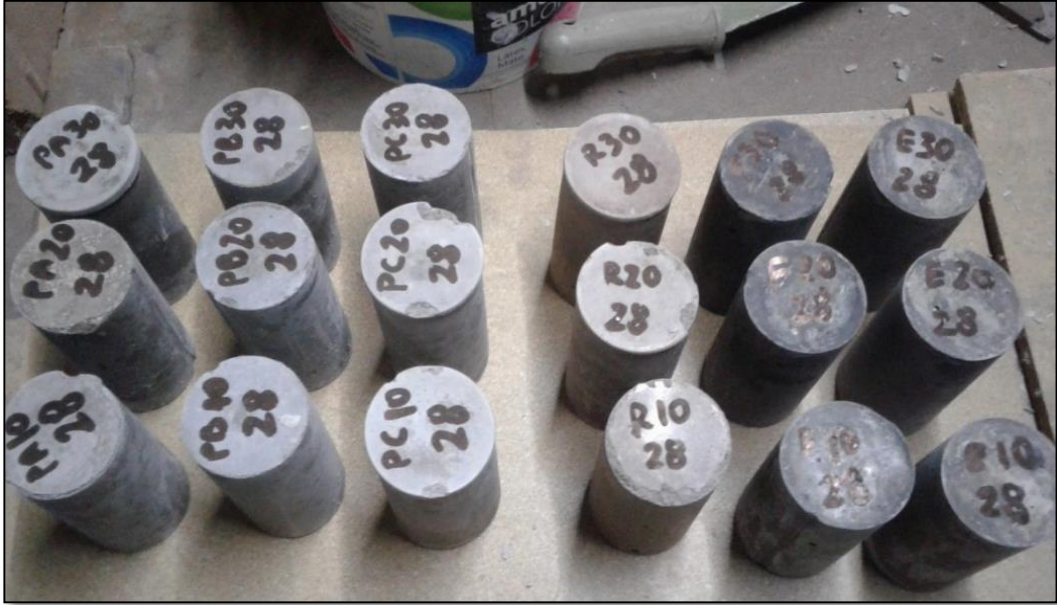
Figura 56. Probetas desmoldadas para el control de 14 y 28 días.
