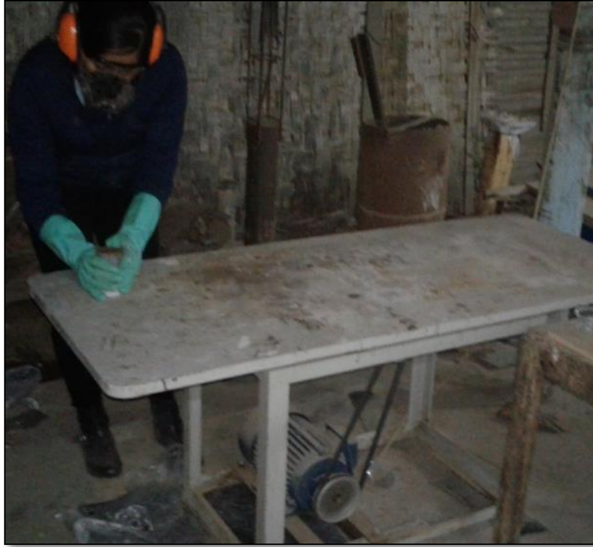
Figura 27. Compactación de la probeta dentro del molde durante 10 segundos.
