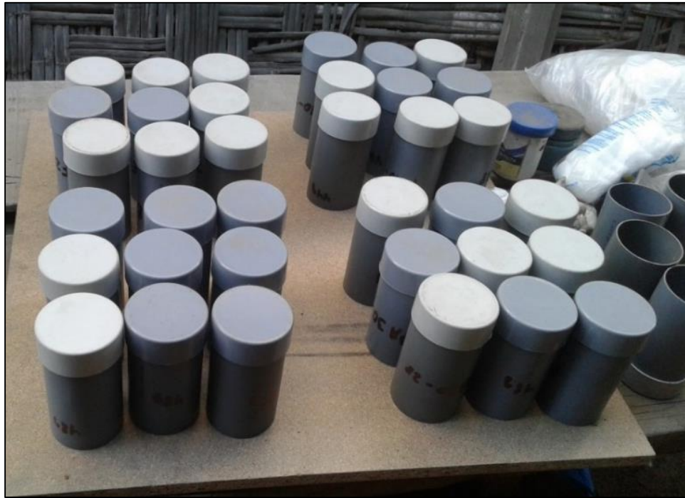
Figura 23. Tubos utilizados para el moldeo de las probetas con sus respectivas tapas y codificadas. Fuente: Elaboración propia.
