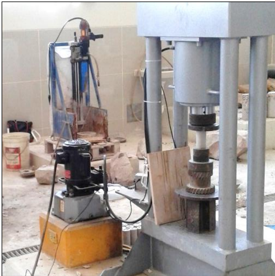
Figura 35. Probeta en el ensayo de compresión a la edad de los 28 días. Fuente: Elaboración propia.
