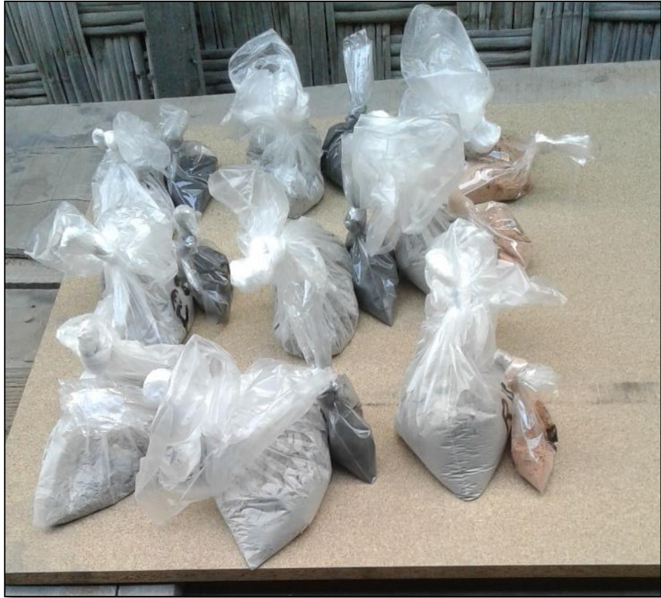
Figura 25. Cantidades de Fly Ash, Escoria y los Rcd usados para el diseño de mezcla a la edad de 28 días. Fuente: Elaboración propia.
