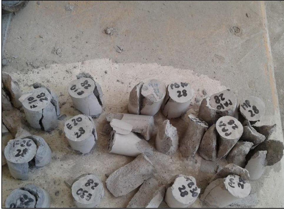
Figura 36. Rotura de la muestra (M1, M2, M3, F, E, R y la MP) a la edad de 28 días.
