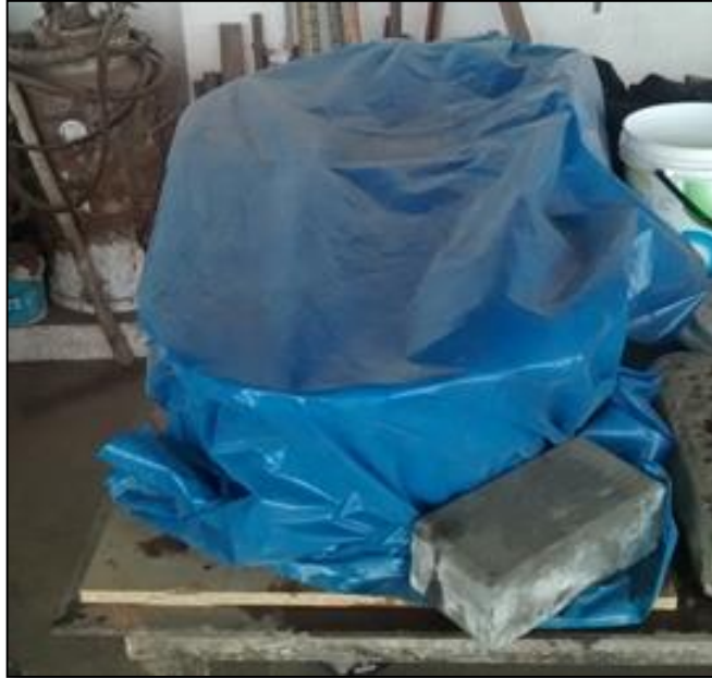
Figura 54. Tapado de las muestras dentro de las bandejas con un plástico para que las briquetas tengan una buena hidratación. Fuente: Elaboración propia.
