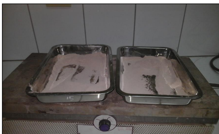
Figura 10. Secado de las puzolanas en una plancha para determinar el % de humedad.
