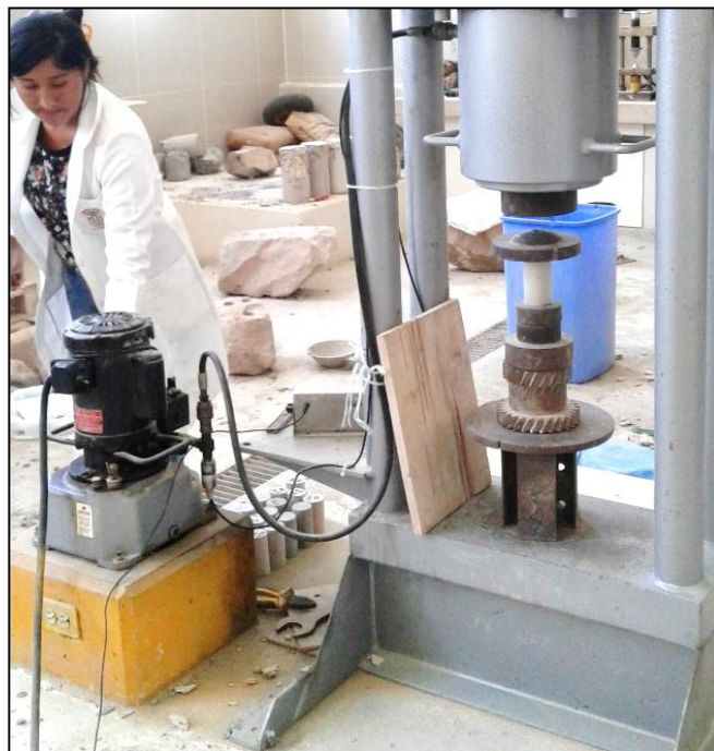
Figura 30. Encendido del equipo e inicio de la rotura de la primera probeta a la edad de 7 días.
