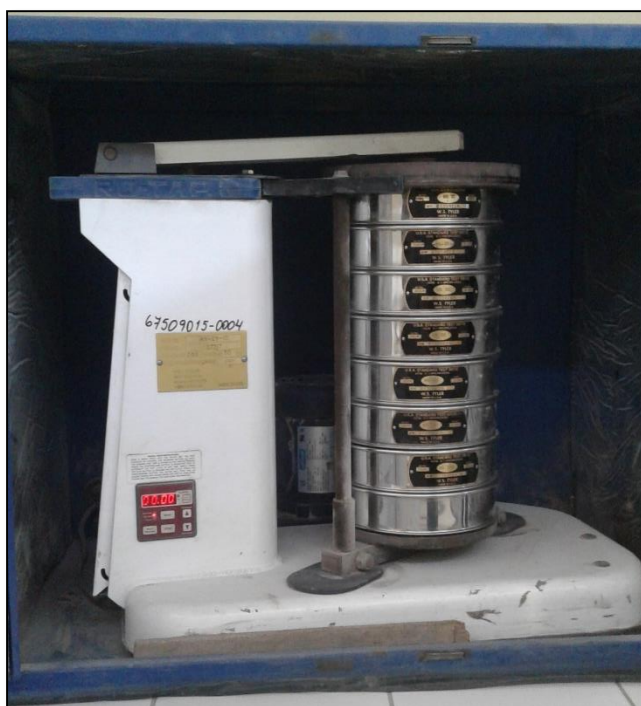
Figura 15. Rotap TYLER modelo R-30050 con el set de mallas utilizadas para la determinación del ANGRA.
