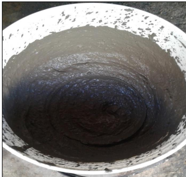
Figura 49: Mezcla homogenizada que se usó para ser moldeada en los tubos de plástico PVC. Fuente: Elaboración propia.
