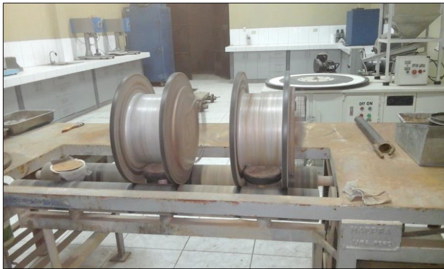
Figura 13. Molinos en funcionamiento de la ESME en el laboratorio de mineralurgia.
