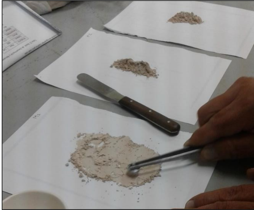
Figura 20. Recolección de la muestra en el accesorio del microscopio. Fuente: Elaboración propia
