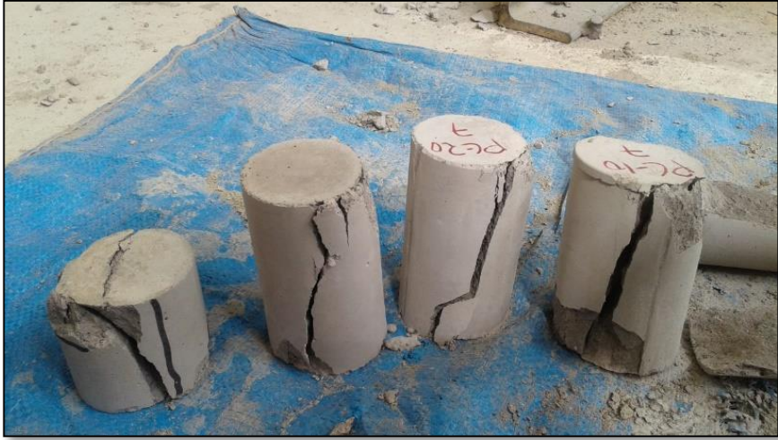
Figura 31. Rotura de las probetas a la edad de 7 días. Fuente: Elaboración propia.
