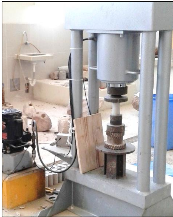
Figura 29. Equipo de compresión utilizada para las roturas de las probetas a diferentes edades de 7; 14 y 28 días.
