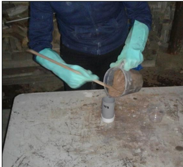
Figura 51. Vaciado de la mezcla en el molde para luego hacer la compactación utilizando la mesa vibratoria.
