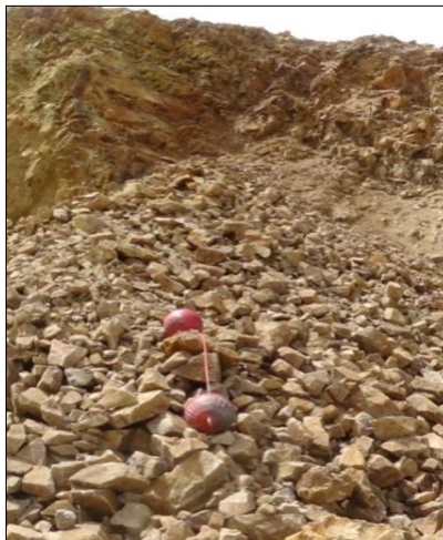
Figura 4.9: Fragmentación óptima Fuente: Elaboración propia
