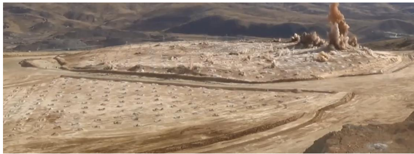
Figura 4.8: Nada de proyección usando Air Deck Fuente: Elaboración propia
