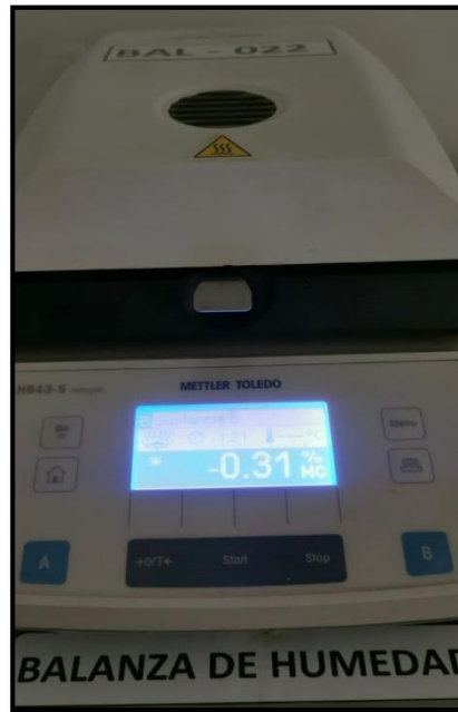
Figura 8. Prueba de % humedad
