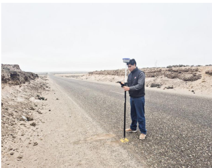
Figura 8 Toma de datos con el receptor GNSS
