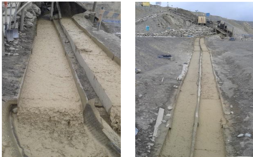
Figura 28. Proceso de obtención del oro en Canaletas
