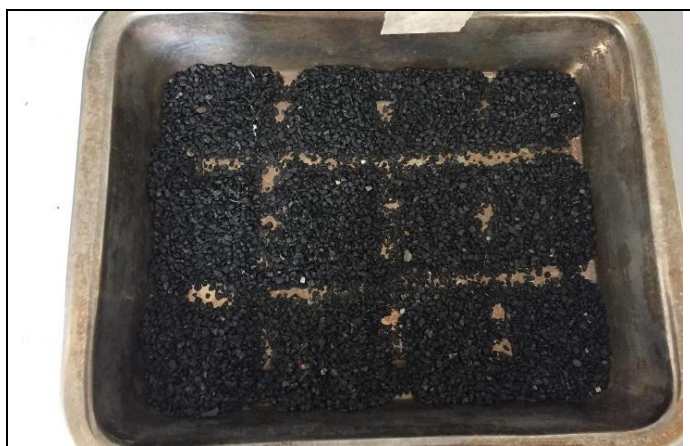
Figura 20. Forma de cuarteo para toma de muestra para el análisis químico del carbón cargado
