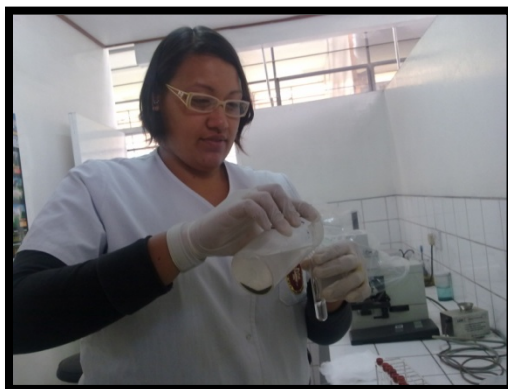
Fig. 4. Llenado del tubo de ensayo con el sedimento de la muestra que fue lavada y posteriormente tamizada.
