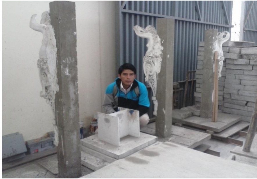
Figura 25. Modelo a escala reducida - muro "H"
