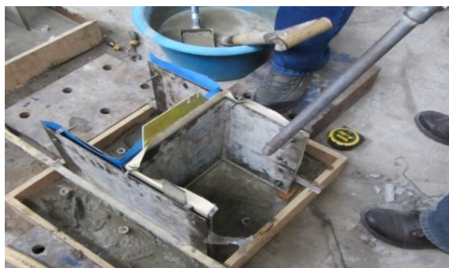
Figura 34. Vaciado del Muro H a escala 1:8
