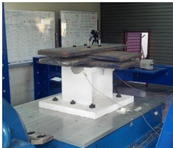
Figura 41. Modelo de muro H a escala en la mesa vibratoria
