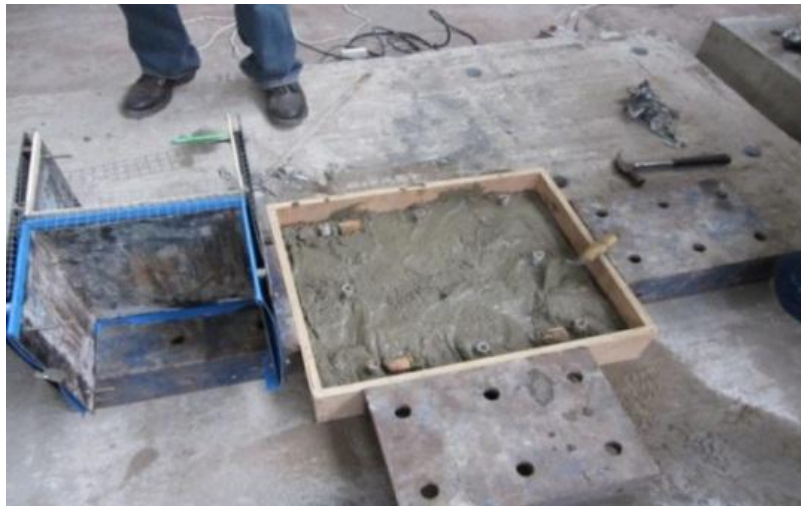
Figura 32. Presentación de los encofrados para la elaboración prototipo
