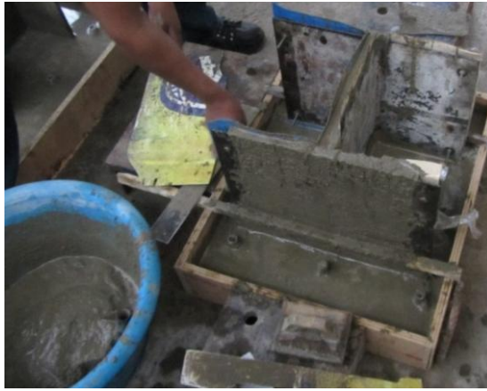
Figura 35. Proceso de vaciado del muro H.
