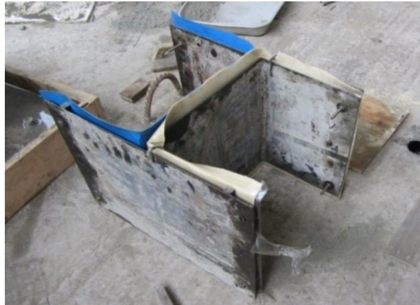
Figura 28. Encofrado metálico del muro H a escala 1:8
