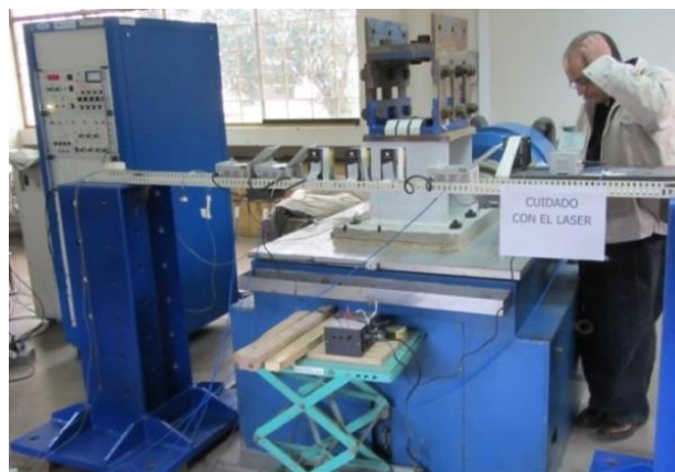
Figura 44. Instalación de sensores en el prototipo
