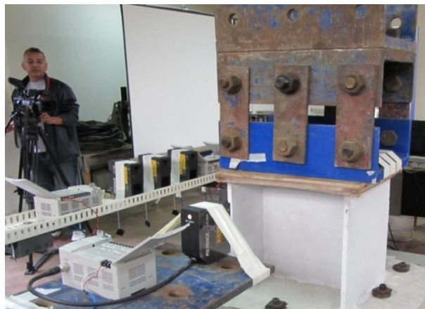
Figura 46. Vista de los sensores laser en el prototipo.
