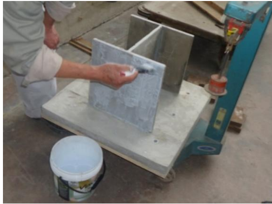
Figura 37. Pintado del muro H.
