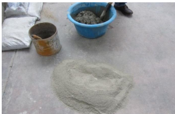
Figura 29. Mezcla cemento – arena gruesa para fabricar el prototipo
