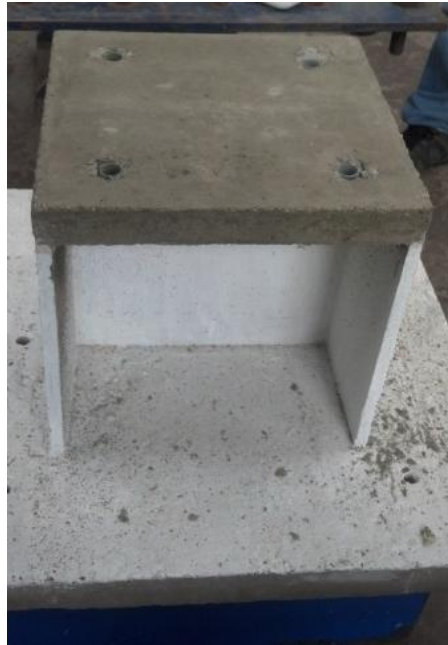
Figura 40. Losa superior de concreto en el prototipo
