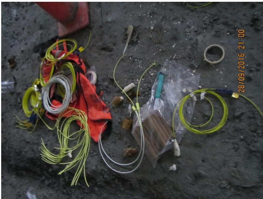
Foto 4: Carga explosiva utilizada como fuente sísmica para la prueba del Tunnel Seismic Prediction (TSP).
