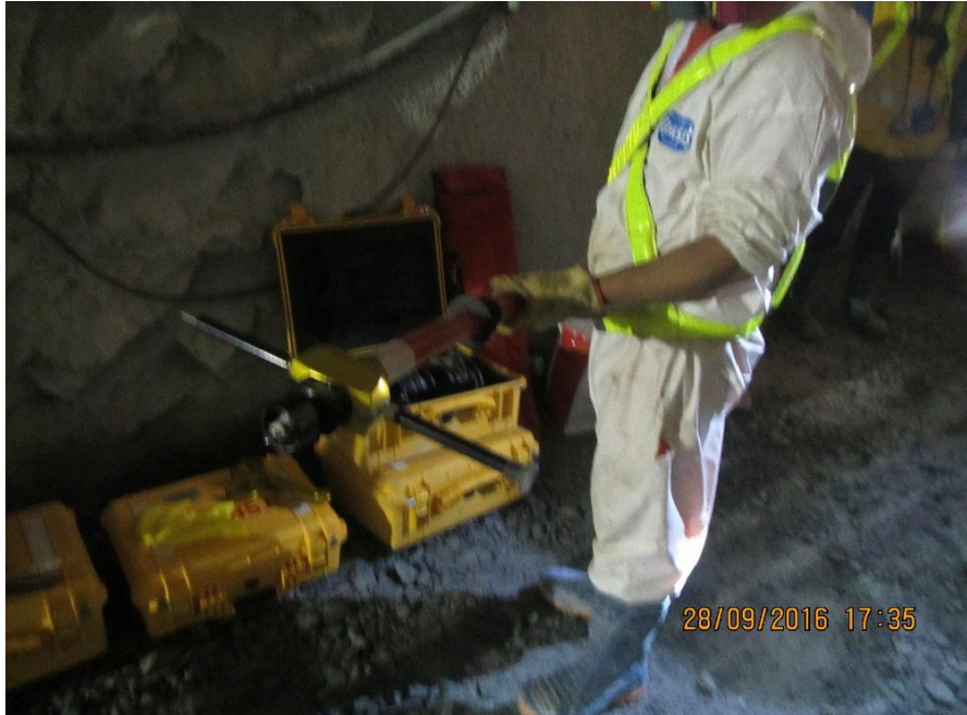
Foto 1: Armado de equipo de TSP-303 (Receptores) para la preparación de obtención de datos.
