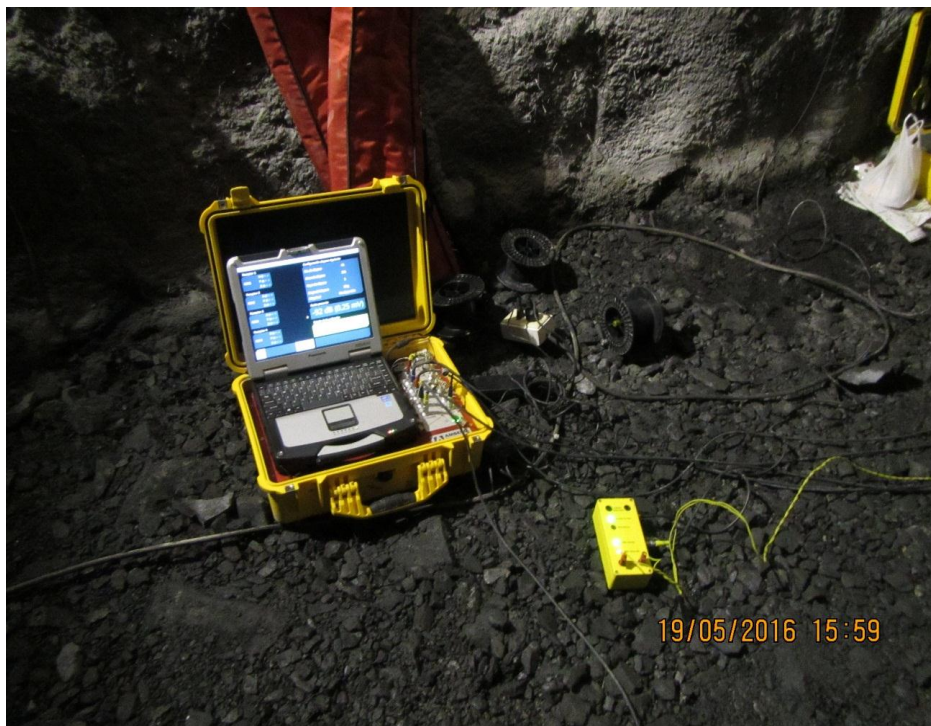
Foto 6: Equipo de Adquisición de datos sísmicos TSP 303 (Tunnel Seismic Prediction)
