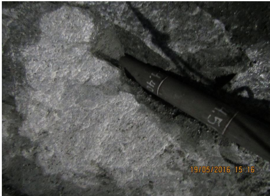
Foto 1: Medición de la Profundidad de los pozos para los Receptores (RCV) en el Túnel Restitución
