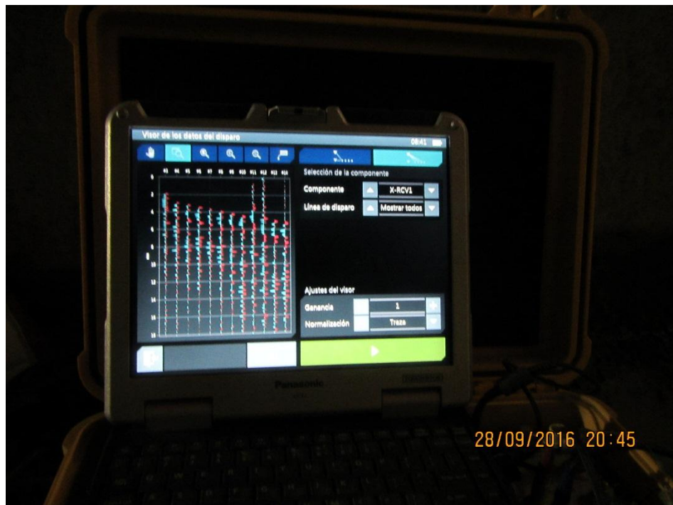
Foto 7: Equipo de Adquisición de datos sísmicos TSP 303 (Tunnel Seismic Prediction)
