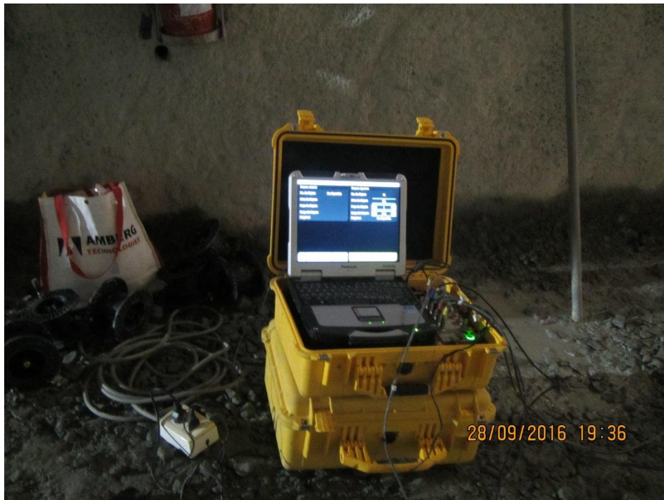
Foto 7: Equipo de Adquisición de datos sísmicos TSP 303 (Tunnel Seismic Prediction)
