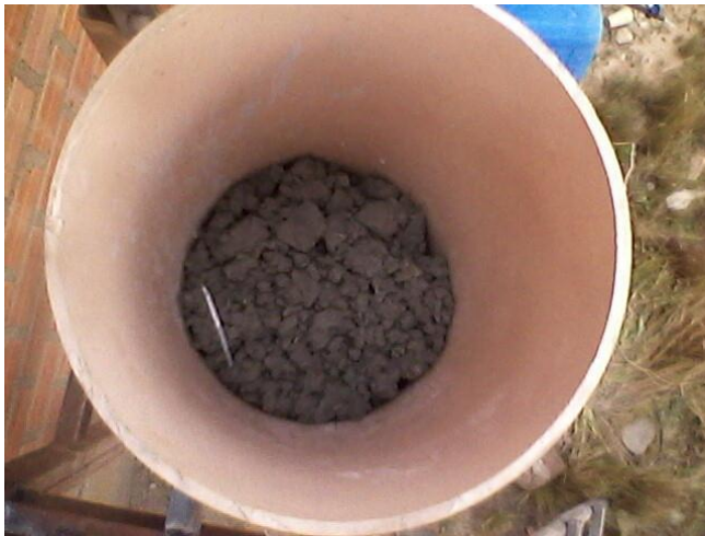
Figura 6. Mineral de desmonte de Pacuani aglomerado y curado dentro de la columna Fuente: Elaboración propia
