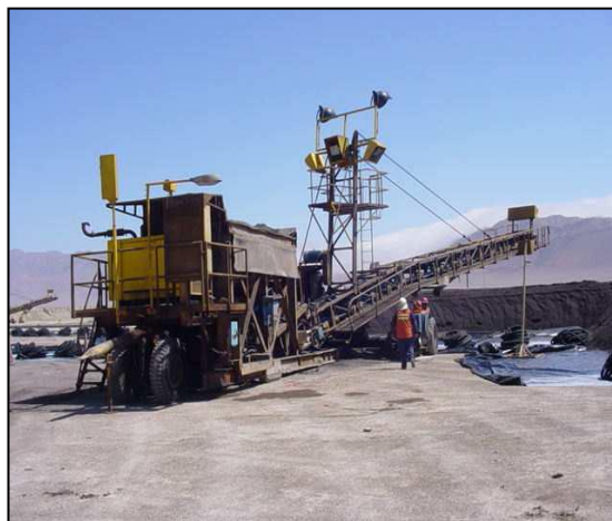
Figura 7. Carguío por apiladores autopropulsados
