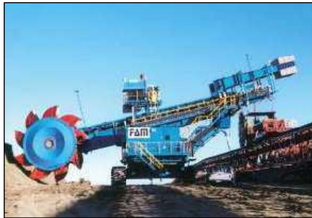
Figura 11. Equipo de descarga de ripios
