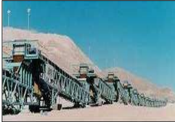
Figura 8. Carguío por sistema de correas cortas y móviles
