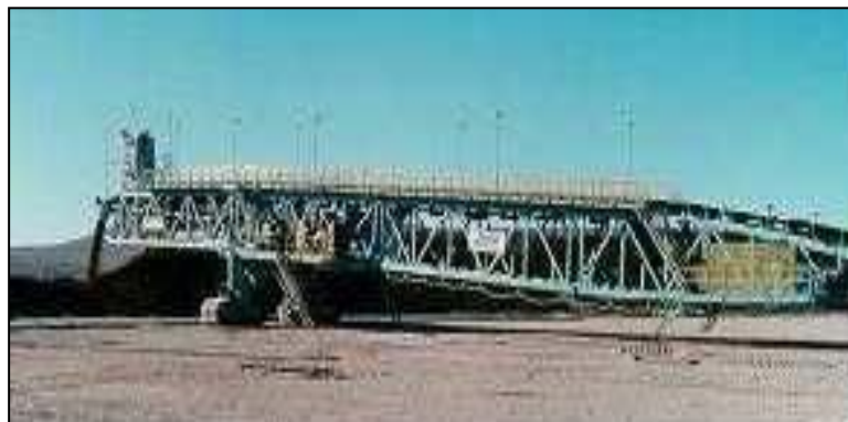
Figura 9. Carguío por apiladores sobre orugas
