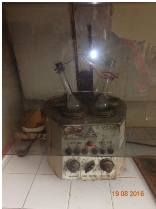
Ilustración 5. Obtención de Proteínas por Kjeldahl
