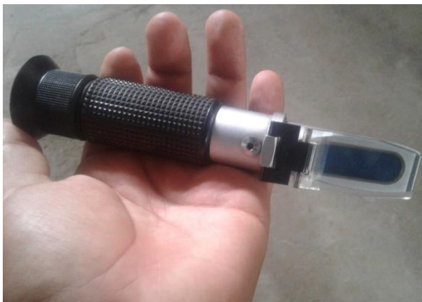
Fotografía 17. Refractómetro utilizado para la medición de grados brix
