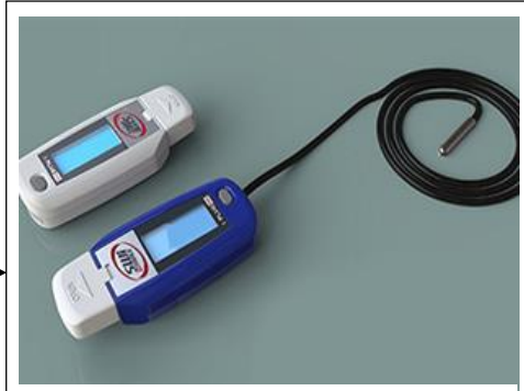
Uso de Dataloggers Iplug para la medición y control de temperatura durante el transporte de las cadenas de frío.
