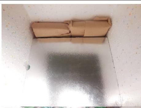
Distribución de hielo en gel en paredes de caja térmica + reforzamiento de caja con cartón de aluminio IPC.
