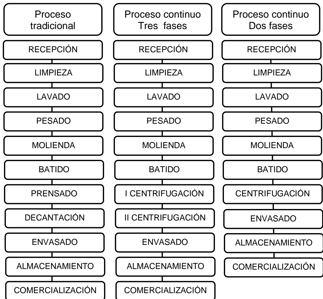
FIGURA 4: Diagrama de flujo de las distintas operaciones que se realizan en cada uno de los tres procesos de extracción de aceite de oliva.
