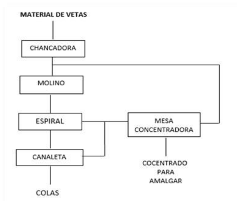
Figura 7. Diagrama de flujo considerando el uso de espirales Fuente: Cano C.M., (1991). Aplicación de espirales en la concentración de minerales. Universidad Mayor de San Andrés, la Paz- Bolivia.
