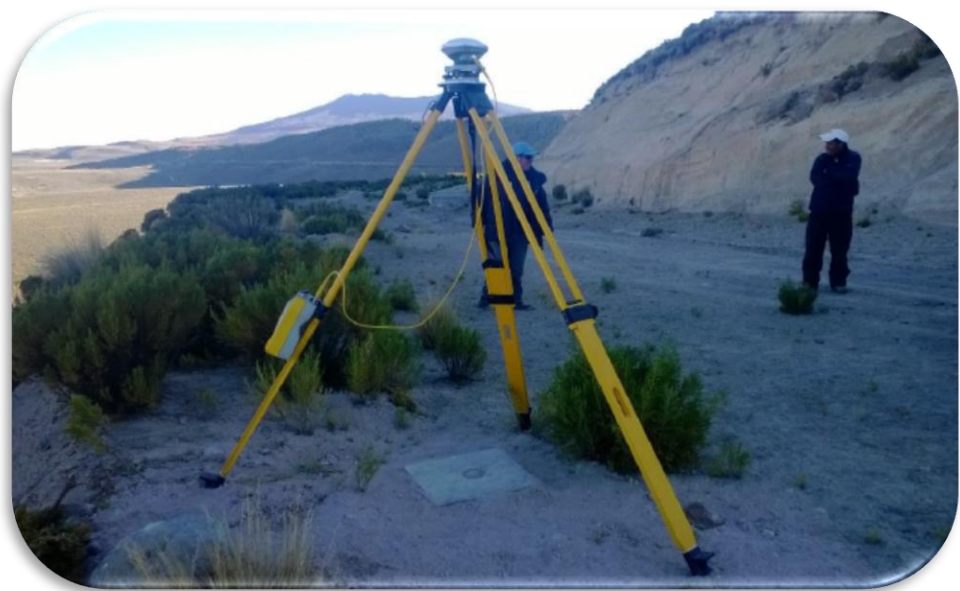
Foto 2. GPS diferencial. Equipo R5 utilizado para el levantamiento topográfico. Por Proyecto Especial Tacna
